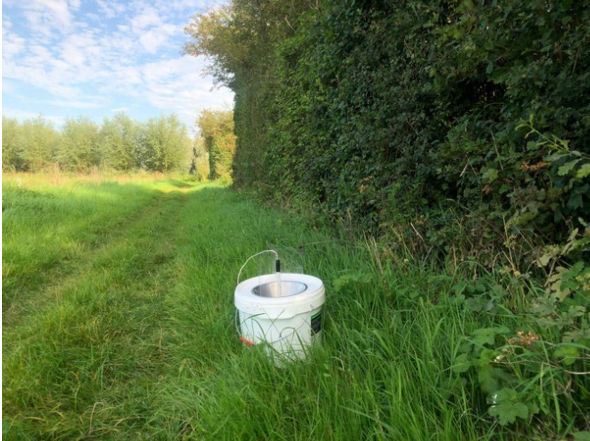
Figuur 4. LED-emmer naast een haag om nachtvlinders te monitoren (foto: Jelle Wissink)
